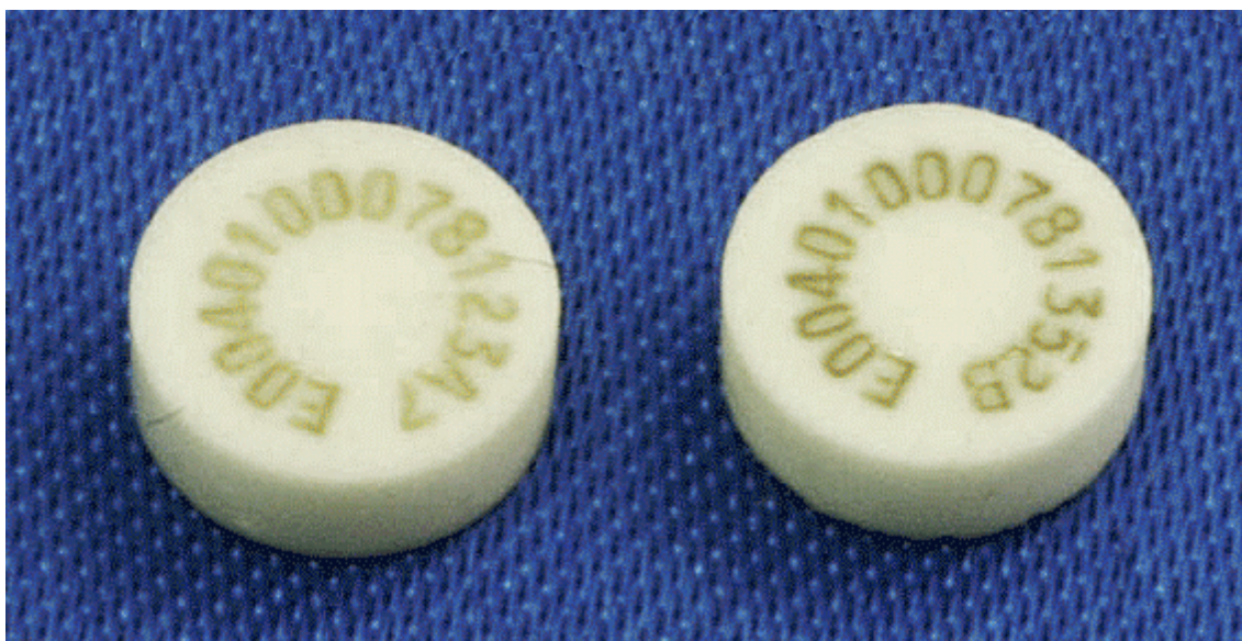
図 3. UID を印字したセラミック IC タグ
