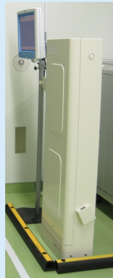
ゲートアンテナ: ラックに乗せたコンテナタグの一括読取り 450x200x1400mm
