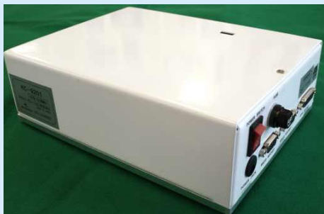
コントローラ: ISO15693 RF4W 160x210x70mm
